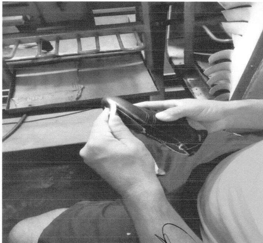
Foto 15 – Operação de unir solado ao cabedal.
